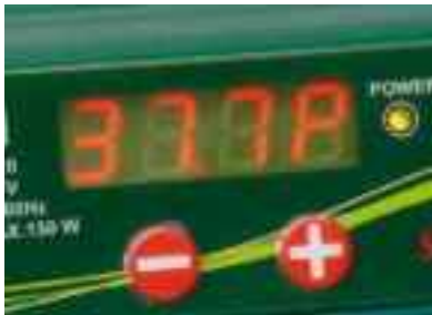
Display mit Soll-Bruttemperatur im Programm-Modus (Temperatur, gefolgt von einem "P")
