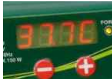
Display mit aktueller Inkubator-Innentemperatur (Temperatur, gefolgt von einem "C")
